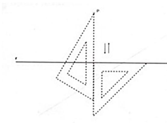
Sem movimentar o esquadro fixo, deslizamos o esquadro móvel para cima, sempre apoiado pelo esquadro fixo. Finalmente, traçamos uma outra reta acima dos dois esquadros. As duas retas construídas desta forma são retas paralelas.
